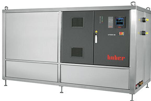
Термостат может охлаждать теплоноситель до отрицательных температур за счет встроенного контура охлаждения, использующего натуральный хладагент. Сама система рефрижерации имеет воздушное охлаждение. Насос и детали, контактирующие с влагой, выполнены из нержавеющей стали и высокопрочной пластмассы. Имеется система защиты от перегрева теплоносителя согласно DIN 12876.
