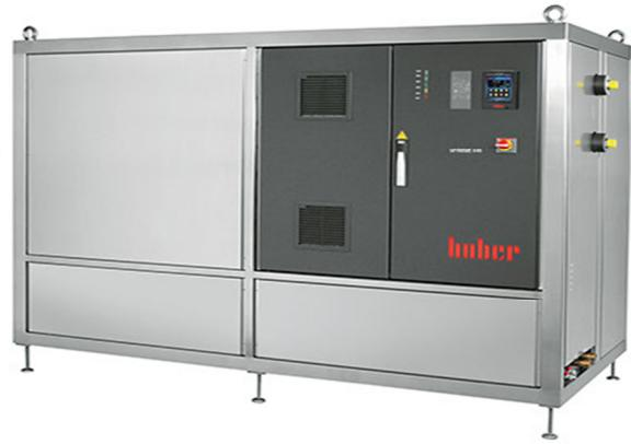
Термостат может охлаждать теплоноситель до отрицательных температур за счет встроенного контура охлаждения, использующего натуральный хладагент. Сама система рефрижерации имеет воздушное охлаждение. Насос и детали, контактирующие с влагой, выполнены из нержавеющей стали и высокопрочной пластмассы. Имеется система защиты от перегрева теплоносителя согласно DIN 12876.
