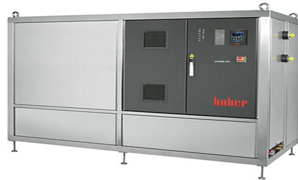
Термостат может охлаждать теплоноситель до отрицательных температур за счет встроенного контура охлаждения, использующего натуральный хладагент. Сама система рефрижерации имеет воздушное охлаждение. Насос и детали, контактирующие с влагой, выполнены из нержавеющей стали и высокопрочной пластмассы. Имеется система защиты от перегрева теплоносителя согласно DIN 12876.
