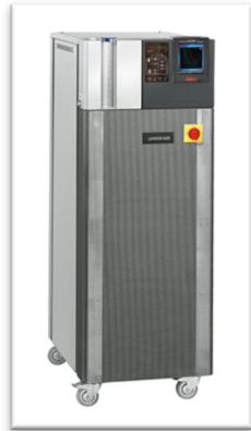
Термостат может охлаждать теплоноситель до отрицательных температур за счет встроенного контура охлаждения, использующего натуральный хладагент. Сама система рефрижерации имеет воздушное охлаждение. Насос и детали, контактирующие с влагой, выполнены из нержавеющей стали и высокопрочной пластмассы. Имеется система защиты от перегрева теплоносителя согласно DIN 12876.
