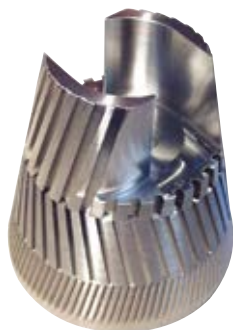
МК – проточный диспергатор с коническими зубьями (коллоидная мельница)
