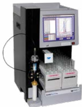
Флеш-хроматограф CombiFlash Rf+ Предназначен для очистки в нормальном или обратном режиме фаз. Совместим с колонками от 4 до 330 г.
